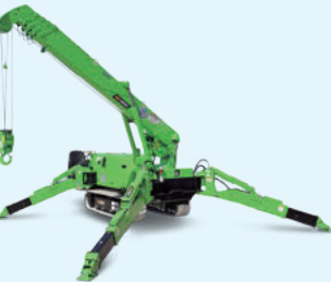
MC285CWMB-3 環境にやさしいリチウムイオン バッテリー式カニクレーン
