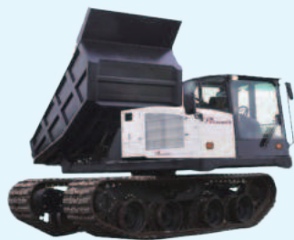
T14R 全旋回型のキャリアダンプ 最大積載量13t
