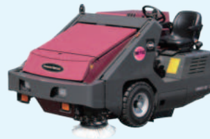
AM9D-3-LH 左ハンドルの搭乗式清掃機 左側清掃(路肩、通路際)の 視認性がよくなり、乗り降りは 歩道側になりました
