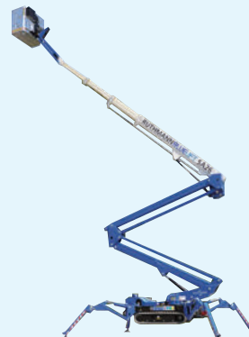
SA26 ハイブリット式 スパイダー型高所作業車
