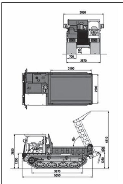
IC100-2 外形寸法(mm)
