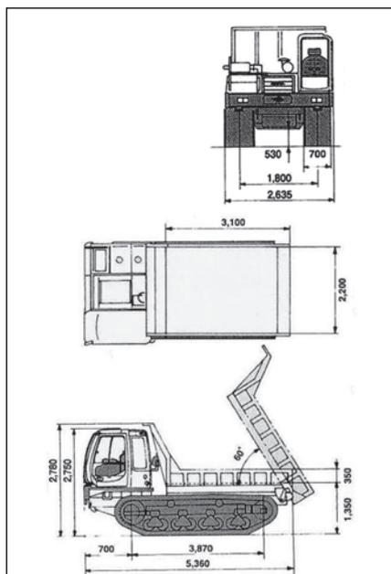
IC70-2 外形寸法(mm)
