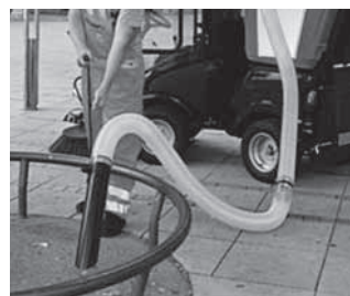
ワンダーホース使用中 ※本体が入り込めない場所のゴミを吸引します。
